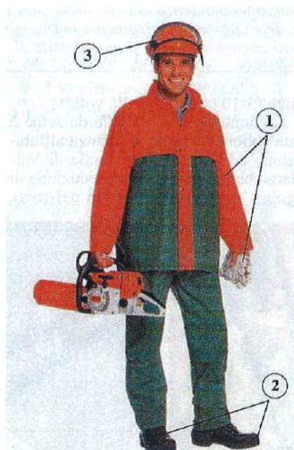
Attrezzatura antinfortunistica da utilizzare quando si impiega la motosega. 1-Tuta e guanti antitaglio. 2-Calzature con puntale di acciaio. 3-Casco con visiera e cuffie
